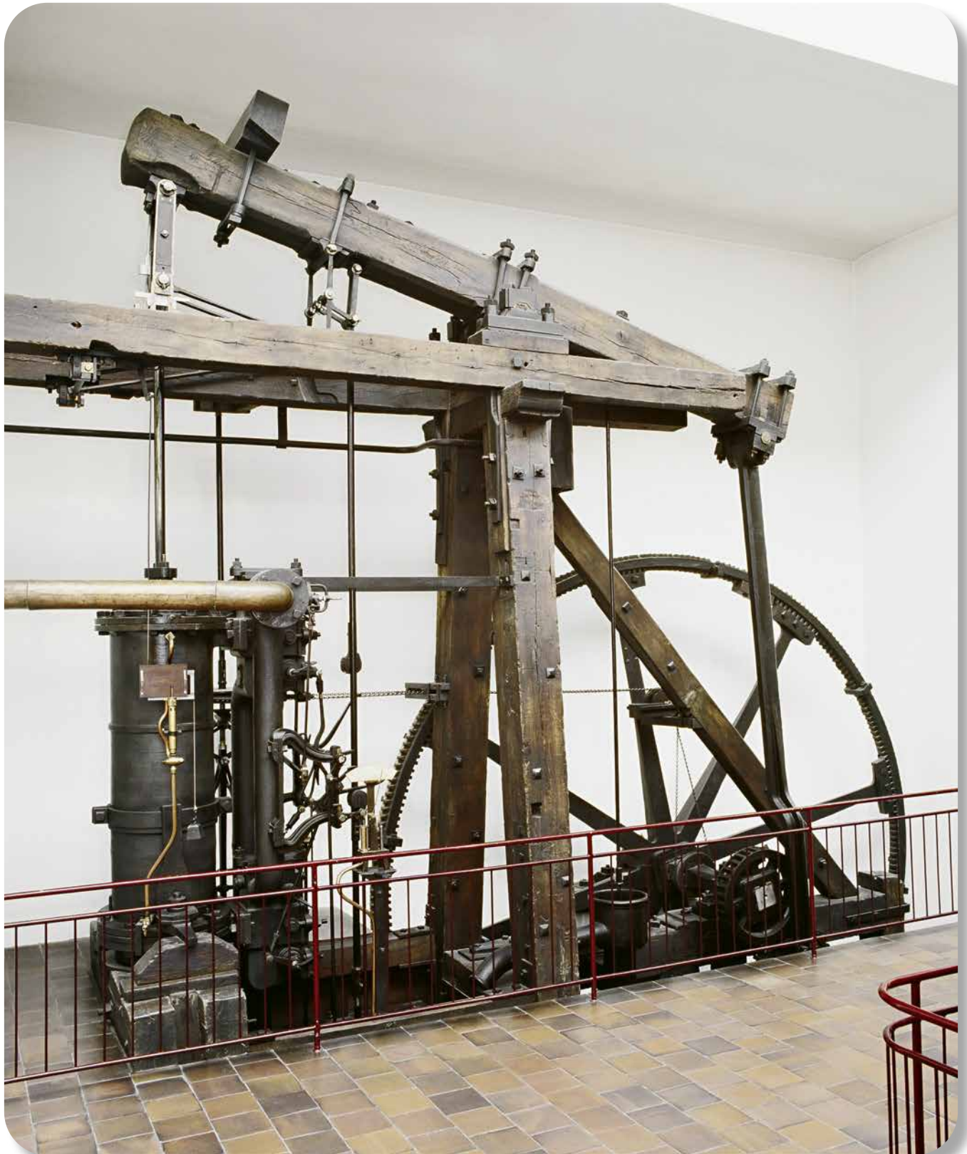
So sah die erste mit Dampf angetriebene Kraftmaschine aus. Diese hier ist eine Nachbildung der ersten Dampfmaschine von James Watt aus dem Jahr 1788, sie steht im Deutschen Museum in München.
