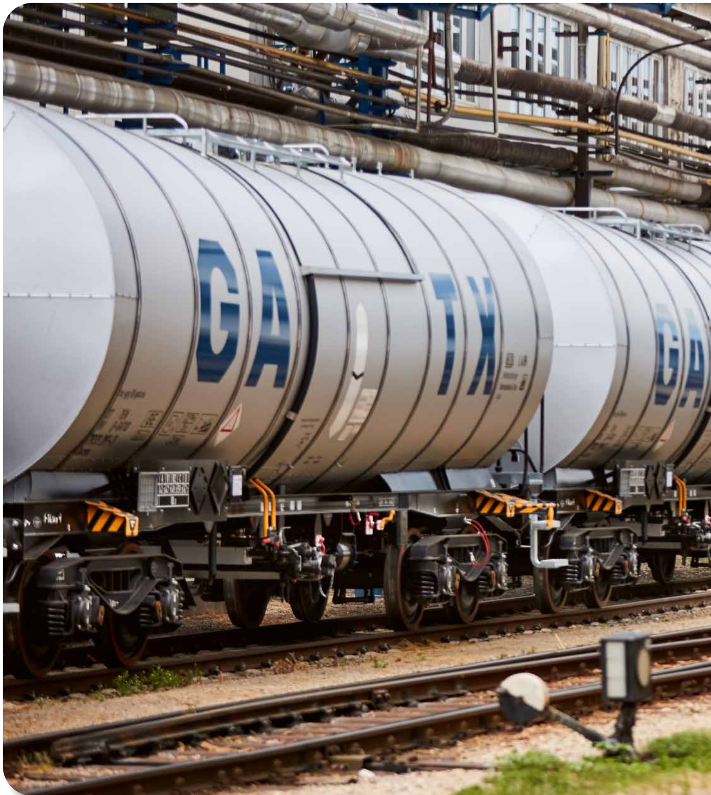
Solche runden Waggonen heißen Kesselwagen. Sie transportieren Flüssigkeiten, zum Beispiel Chemikalien. In diesem Werk werden die Wagen mit Chemikalien befüllt.
