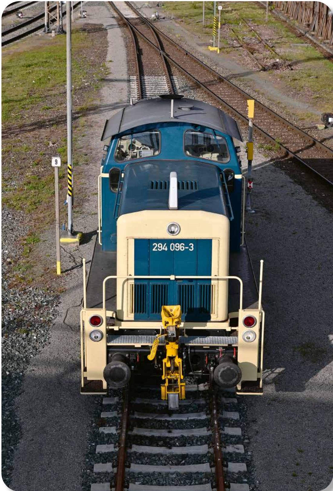
So eine Lok zieht Güterwagen: Das hier ist eine Rangierlokomotive mit Dieselmotor.
