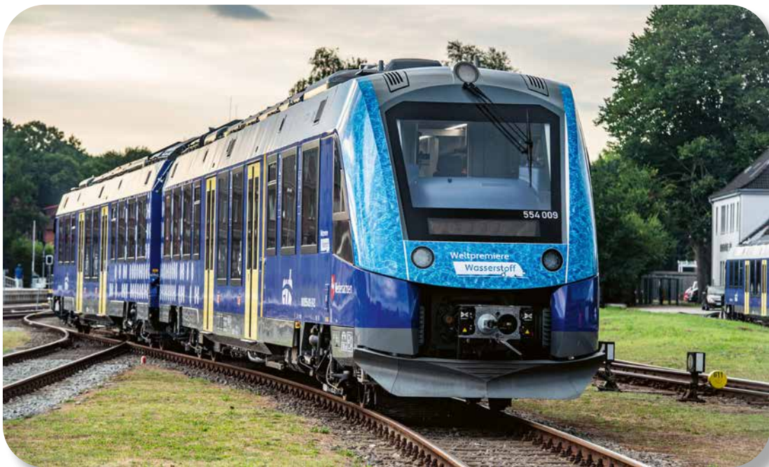
Dieser Wasserstoffzug heißt Coradia iLint und fährt mit Brennstoffzellen-Antrieb.
