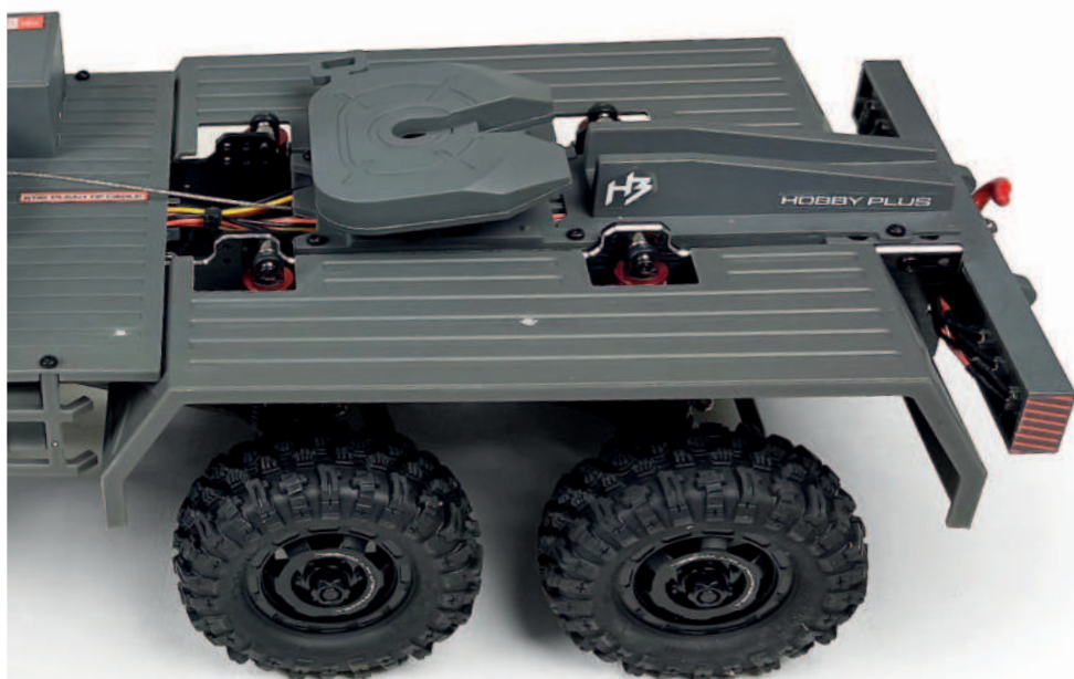
Über diesen Schieber-Button lässt sich die Kabine einfach entriegeln und gibt Zugang zum 1100 mAh 2S-LiPo Fahrakku
