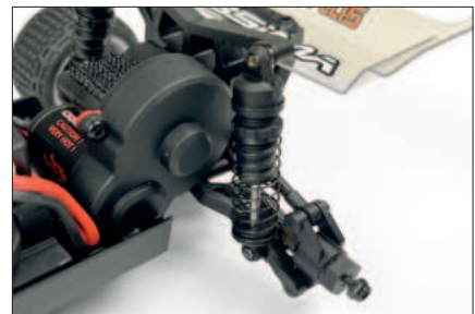
Die Antriebszahnäder sind hinter einem Cover vor Staub und Dreck geschützt
