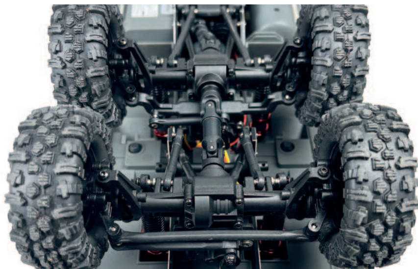
CVD-Wellen an allen Achsen sorgen für Festigkeit und großzügigen Lenkwinkel
