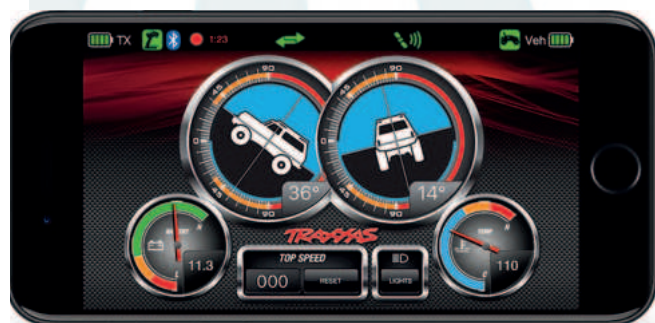
Der Neigungsmesser zeigt während der Fahrt die Vorwärts- und Seitenneigungswinkel
