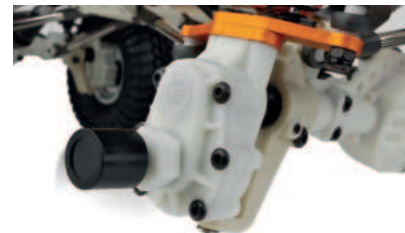
Metallzahnräder, verstärkte Lageraufnahmen und ein robuster Aufbau sorgen für höchste Belastbarkeit
