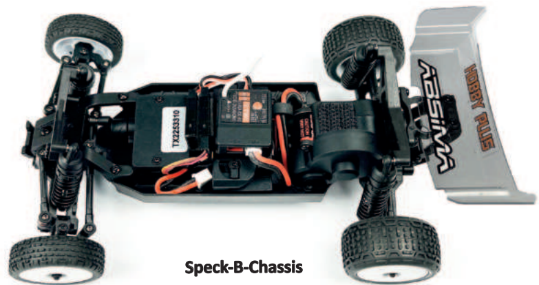
Unter dem Empfänger-/Regler-Einheit findet der 2S-LiPo-Fahrakku seinen Platz
