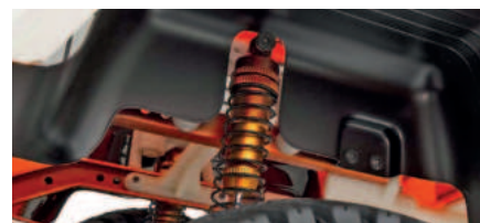
Die goldenen Aluminium-Stoßdämpfer sind mit Gewinde versehen
