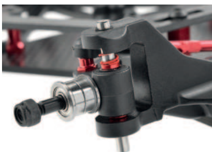
Die Querlenker mit fixiertem Sturz (0,5°) und Nachlauf (6°) sorgen so für exzellentes Ein- und Auslenkverhalten in Kurven
