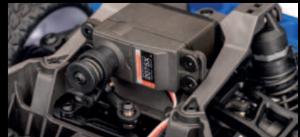
Gelenkt wird mit wasserdichtem Metallgetriebservo
