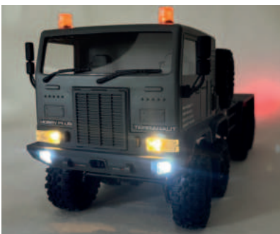
Ferngesteuerte Beleuchtung mit 5 verschiedenen Modi und drehbaren gelben Rundumleuchten
