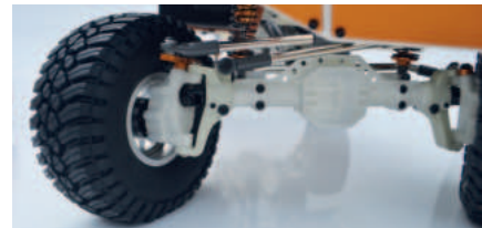
Portalachsen mit nahezu 2,5 cm zusätzlicher Bodenfreiheit
