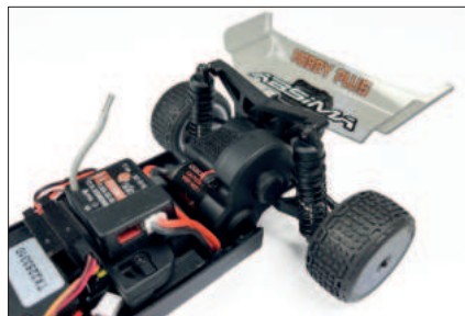
Unter dem Empfänger-/Regler-Einheit findet der 2S-LiPo-Fahrakku seinen Platz
