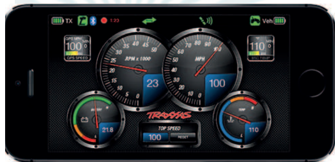
Sensoren zur Anzeige in Echtzeit von Geschwindigkeit, Batteriespannung, Drehzahl und Temperatur
