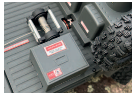
Ferngesteuerte Bergungswinde mit Edelstahlseil und Metallhaken
