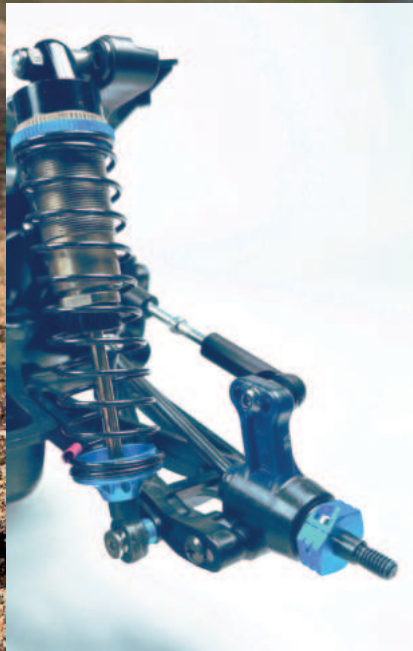
Die Hinterachse verfügt über Aluminium Sechskant Felgenmitnehmer
